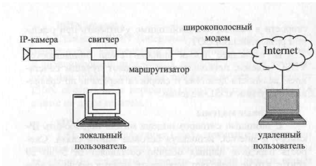
Рис.12 - Схема работы IP-камер с глобальных сетей
